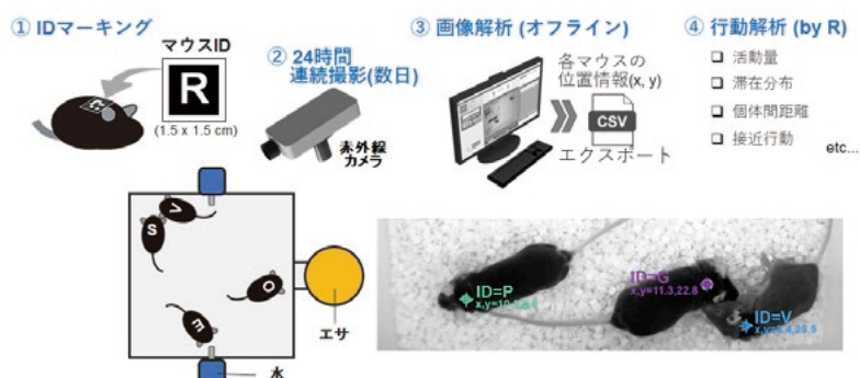
図1: 画像解析技術による集団飼育下行動解析システムの模式図 個体識別のため、マウスの背にマウスIDをマーキングする。集団生活の様子を赤外線カメラにより昼夜連続撮影を行う。独自開発したソフトにより各マウスのIDを認識し、その位置情報を算出する。データはCSV形式でエクスポートされ、各マウスの行動分析のための二次解析を実施する。
