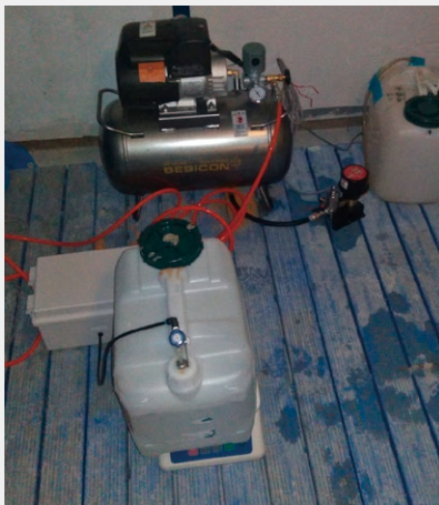
Fig. 3 噴霧システムの写真
