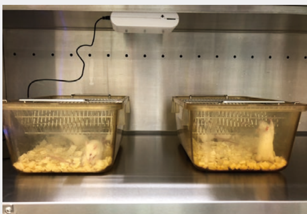
図4. センサーをラック天井面に設置した例
