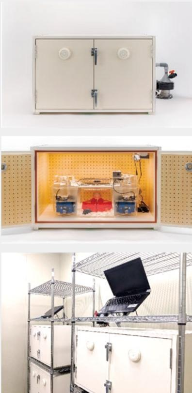
図5. 専用の「アイソレーションボックス」を利用したIntelliCageシステム専用実験環境
