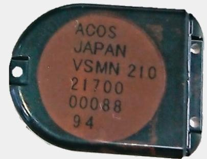
図3. 運動量/温度計測装置 nano tag (18.8mm×14.2mm×7.1mm, 2.7g)
